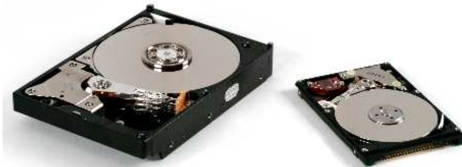
Disques durs 3,5 pouces (à gauche) et 2,5 pouces (à droite).
